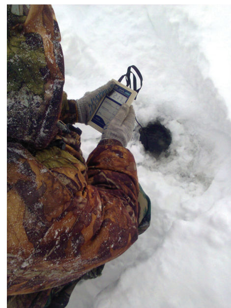
Замер концентрации кислорода.
